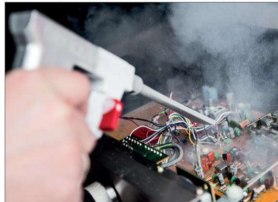
Selbst elektronische Bauteile kann man trocken eisstrahlen
