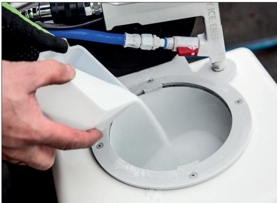
Bei Bedarf können dem Trockeneis abrasive Strahlmittel beigesetzt werden, hier z.B. Glasperlen
