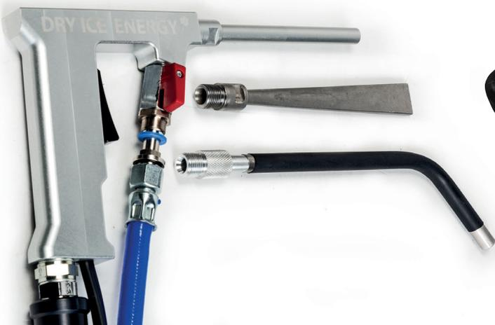
Ein weiterer Vorteil ist, dass es keine Trocknungszeiten gibt; werden z.B. Polster oder andere Untergründe, die Wasser aufsaugen, gereinigt, muss nach der Reinigung eine Trockenphase eingehalten werden. Beim Einsatz von Trockeneis sind keine Trockenzeiten notwendig.
