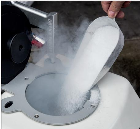
Die passenden Trockeneis pellets, mit denen die Maschine befüllt wird, werden von Dry Ice Energy geliefert
