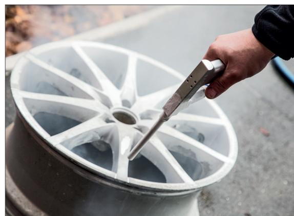
Setzt man dem Trockeneis abrasive Stoffe bei, etwa Glasperlen, kann man auch Lackreste etc. von Oberflächen holen
